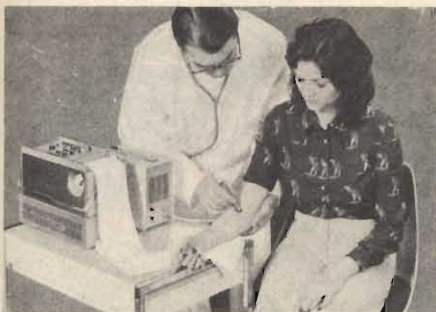
Fig. 12 - Rivelatore ultrasonoro ad effetto Doppler per vasi sanguigni, della SIEMENS.
