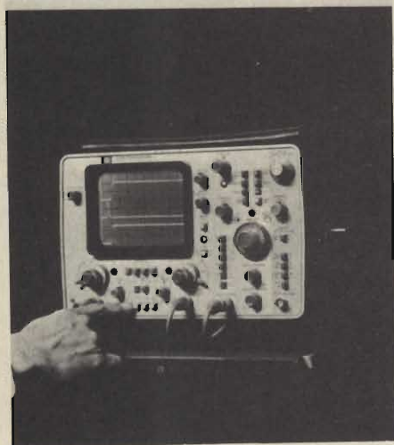
Oscilloscopio HEWLETT PACKARD modello 1740 A per ben comprendere le relazioni di fase tra due treni di impulsi occorre visualizzare il segnale di trigger come terza traccia.
