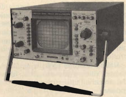
Oscilloscopio modello LBO-520 della ditta giapponese LEADER; ha la banda passante di 30 MHz.
