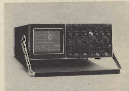
L'oscilloscopio Philips modello PM 3214 con doppia base dei tempi e linea di ritardo. La fotografia lo mostra mentre ingrandisce di 10 volte i particolari che nelle due tracce superiori sono indicati da una traccia più intensa.
