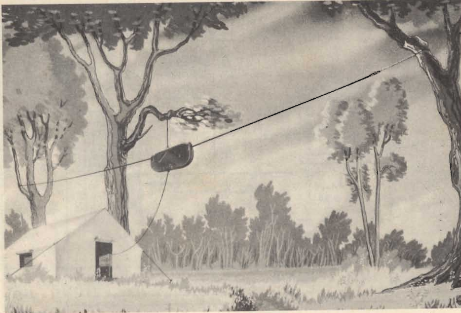
Fig. 8 - Antenna portatile, a dipolo raccorciabile in funzione della frequenza. Gamma 1.500 ÷ 30.000 kHz.
