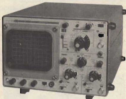
Oscilloscopio VP 5260 A della National. Il calibratore può fornire tre tensioni.
