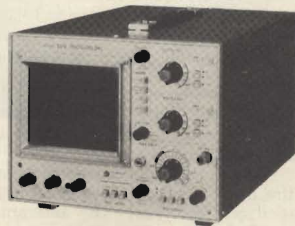
L'oscilloscopio modello 5514 della KIKUSUI; sul commutatore della base dei tempi è indicato quale modo di funzionamento viene selezionato.
