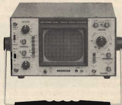
Oscilloscopio LEADER modello LBO 508-A con larghezza di banda di 20 MHz, ed in grado di eseguire somma e differenza algebrica fra i segnali di ingresso.
